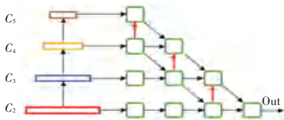
图3 具有更高精确度和计算效率的TFA网络结构
